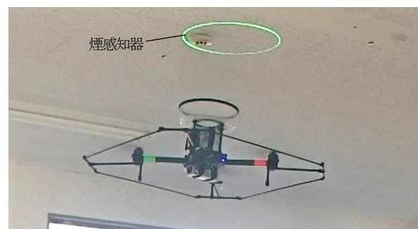
図5 既存ドローンの改良例 煙感知器点検用ドローン
