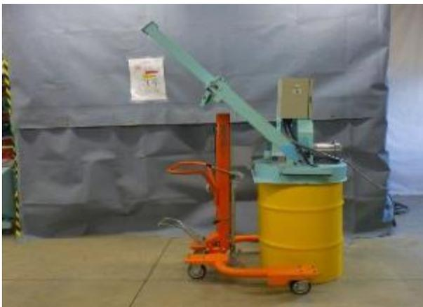
図2 破碎機外観(40W形用投入シャフト取り付け時)
