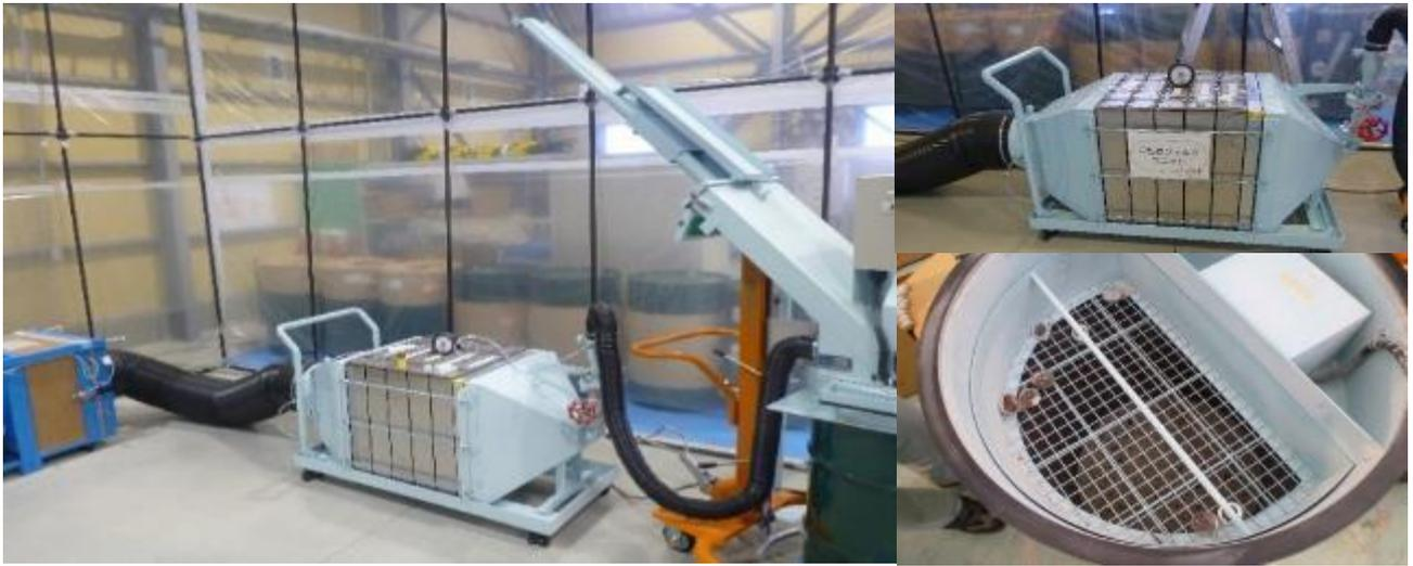
再処理施設の放射線管理区域内で使用されている照明器具のうち、使用済み蛍光灯は汚染の有無を判断できないことから放射線管理区域内で保管されており、保管スペースを圧迫している。そこで、放射線管理区域内で使用済み蛍光灯を破碎する装置を開発し、この装置を用いて使用済み蛍光灯の破碎・減容作業を行った。これによって大幅に廃棄物容量低減に貢献した。
