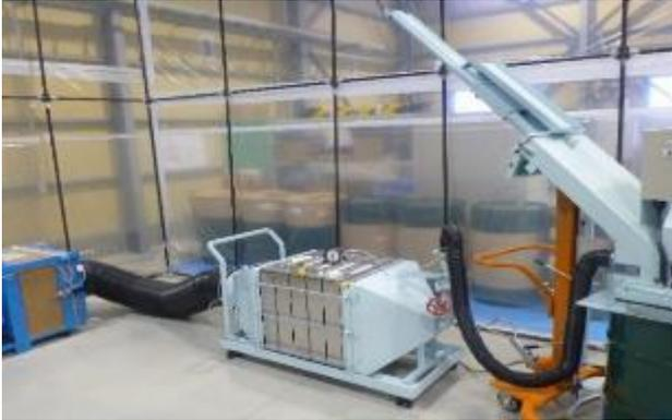
図6 蛍光灯破碎ユニットの外観
