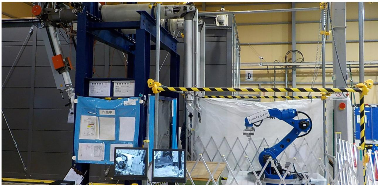
六ヶ所再処理工場のガラス溶融炉の解体現場では、ITV（Industrial TeleVision）カメラを使用した遠隔解体が解体作業全体の約 8 割を占めており、遠隔機器から対象物までの距離および空間認識が難しいことから、高度な遠隔操作技術が求められる。そこで、当社の訓練施設（ジェイテック技術・訓練センター：JTTC）に解体現場を模擬した訓練設備を導入し、遠隔機器の操作技術向上に努めている。
