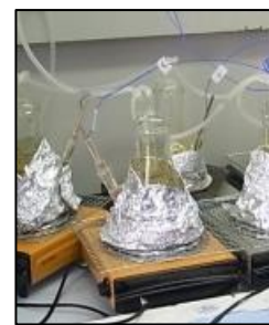
図9 腐食試験実施様子
