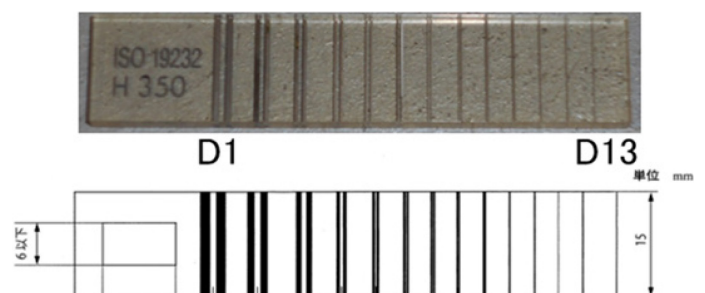
図7 複線形像質計の構造
